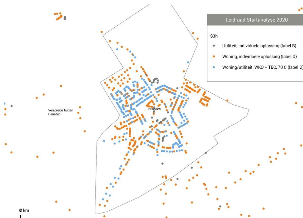
Figuur 12: Goedkoopste scenario voor de buurt Heusden (CBS indeling 2018) op basis warmtenet met lage temperatuurbron.
