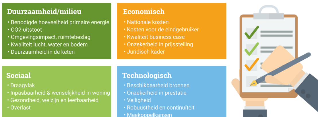
Figuur 2: Afwegingskader voor het kiezen van een aardgasvrije techniek in een buurt
