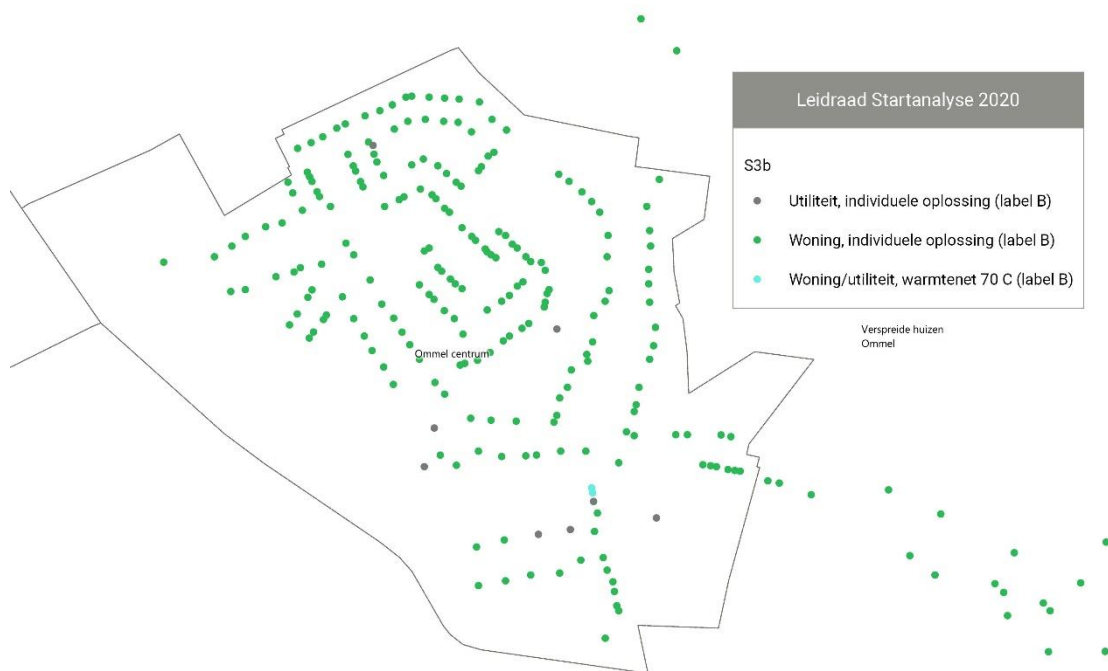
Figuur 8: Scenario Warmtenet met Lage temperatuurbron – variant LT warmtebron aanlevering op 70 °C, woningen schillabel B
