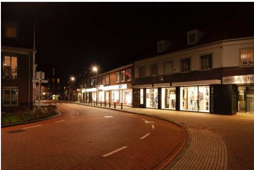
Foto: Emmastraat in het centrum van Asten. Verlichte etalages zorgt voor veel randverlichting. Hier is het veiliger om de rijweg te verlichten zodat er geen donker gat valt.
