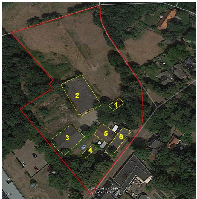
Fig.3 Het plangebied is rood omkaderd. De te slopen bebouwing is genummerd en geel omkaderd.
