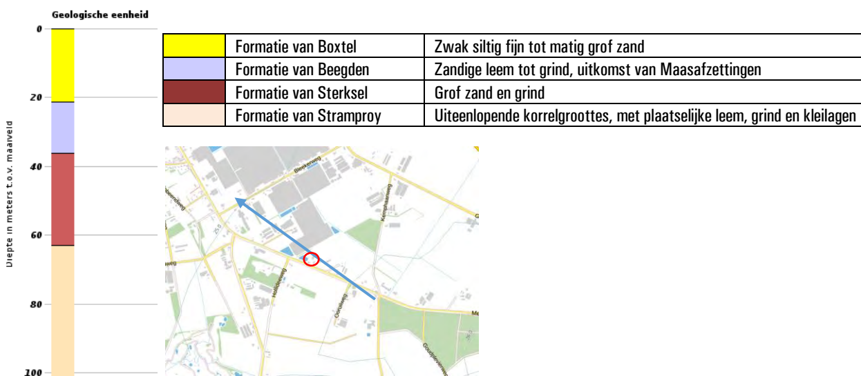
Figuur A: opbouw ondergrond.
