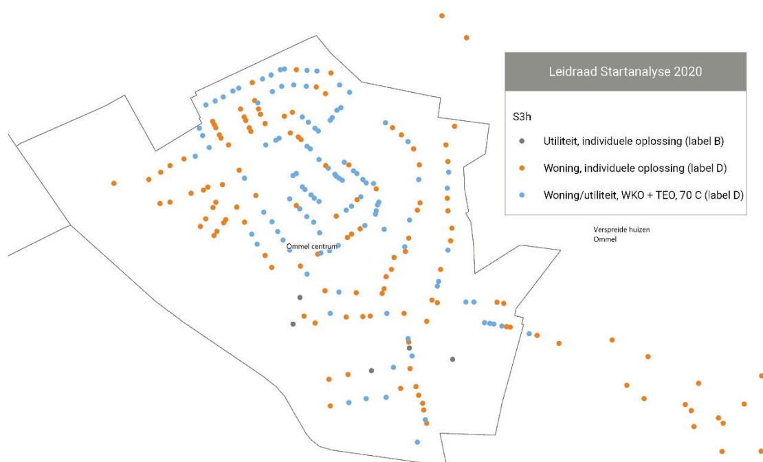
Figuur 9: scenario Warmtenet met Lage temperatuurbron – variant TEO+ WKO aanlevering op 70°C, woningen schillabel D.
