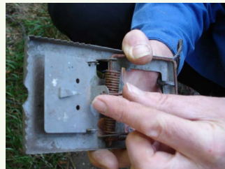
► Stap 3: steek de borging door het plaatje (blijf daarbij de beugel vasthouden!)
